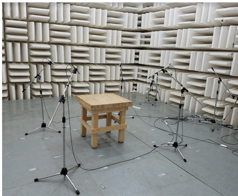
Figur 9: Testopplegget Foxconn CMC ekkofritt kammer med <6 dBA bakgrunnsstøy
