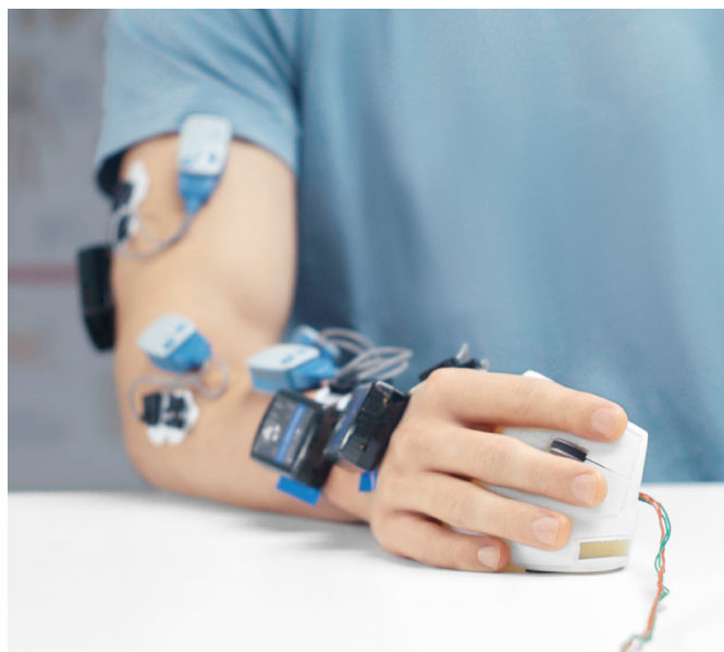
Logitechs ergonomiske testing med bevegelsessensorer
