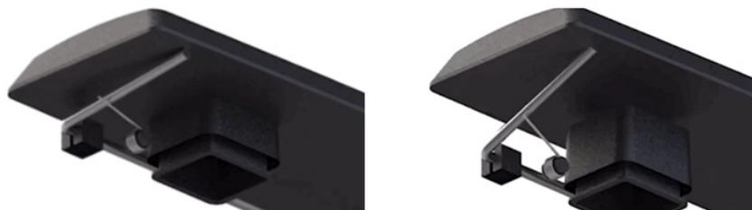
Figura 4: Il design con molle di torsione contribuisce alla riduzione del rumore mantenendo vicine la copertura del tasto e la barra di bilanciamento
