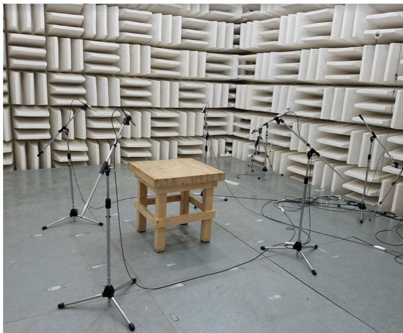
Figura 9: Test eseguiti presso Foxconn CMC in camera anecoica con rumore di fondo < 6 dBA
