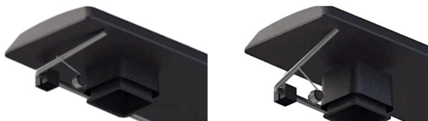
Figur 4: Torsionsfjeders konstruktionsdesign hjælper med at reducere støj ved at holde balancestangen og tasten tæt sammen
