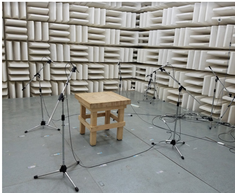
Figur 9: Testopsætning ved Foxconn CMC anechoisk kammer med <math><6\text{ dB}</math> baggrundsstøj
